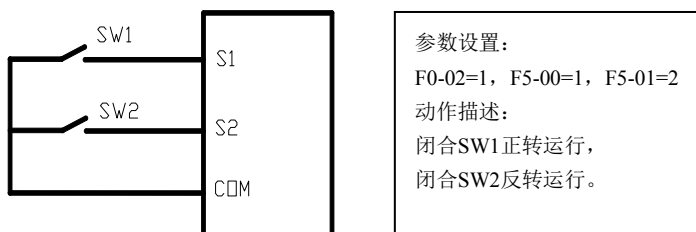
图4-4 两线制端子启停控制方式举例
