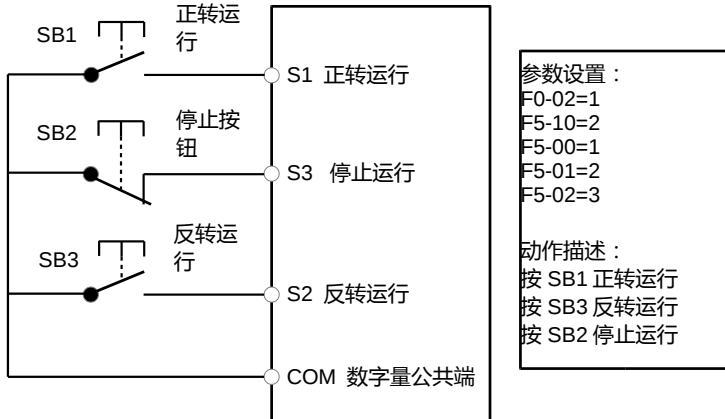
图4-5 三线制端子启停控制方式举例
